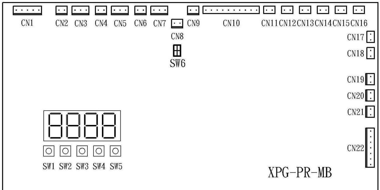
①按 SW1 可切換相電壓、線電壓、電流、頻率、KW、KVA、PF
